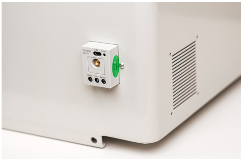
Seitenansicht, optional verbautes LORA-Modul
